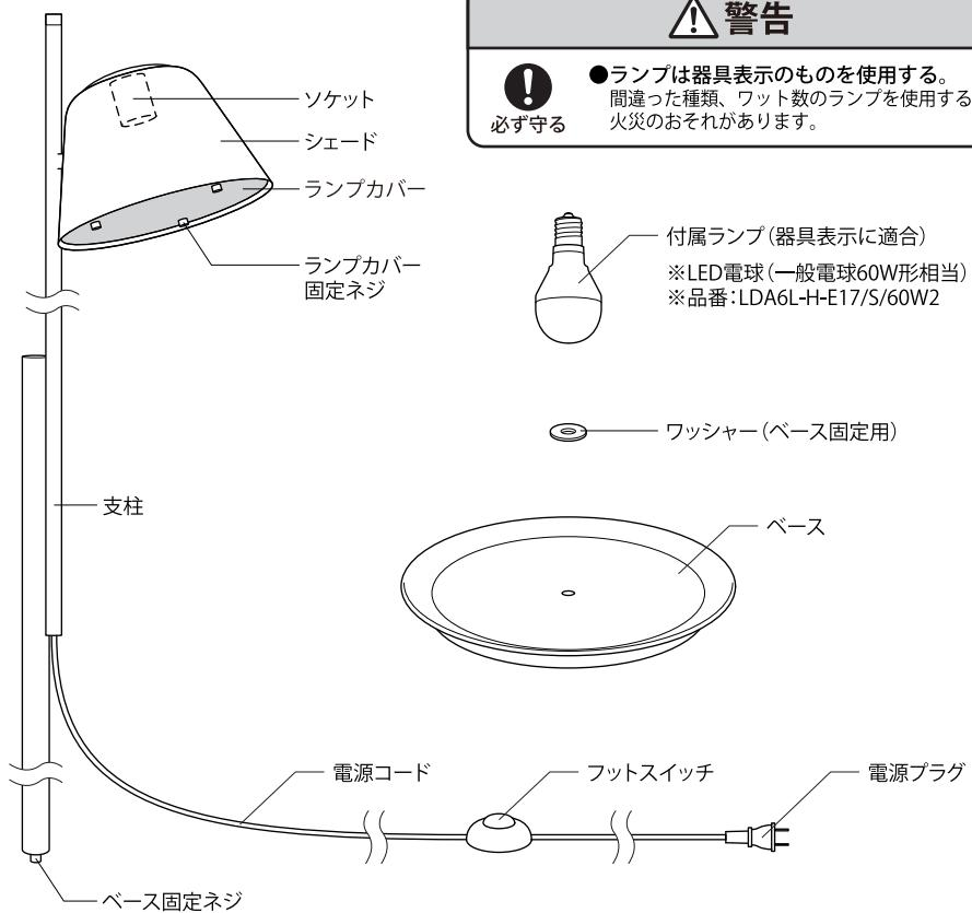
カバー固定ネジを外し、ランプカバーを取り外します。
